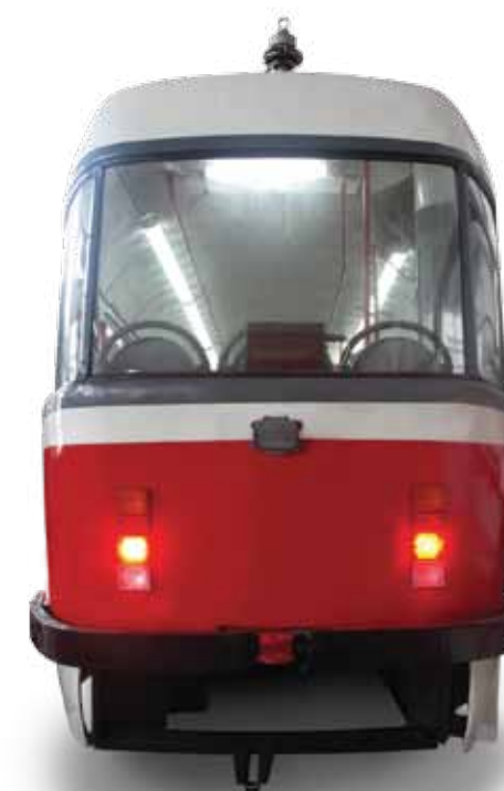
Вагон Татра Т-3, прошедший ремонт с модернизацией на «ТМЗ им. В.В. Воровского»
