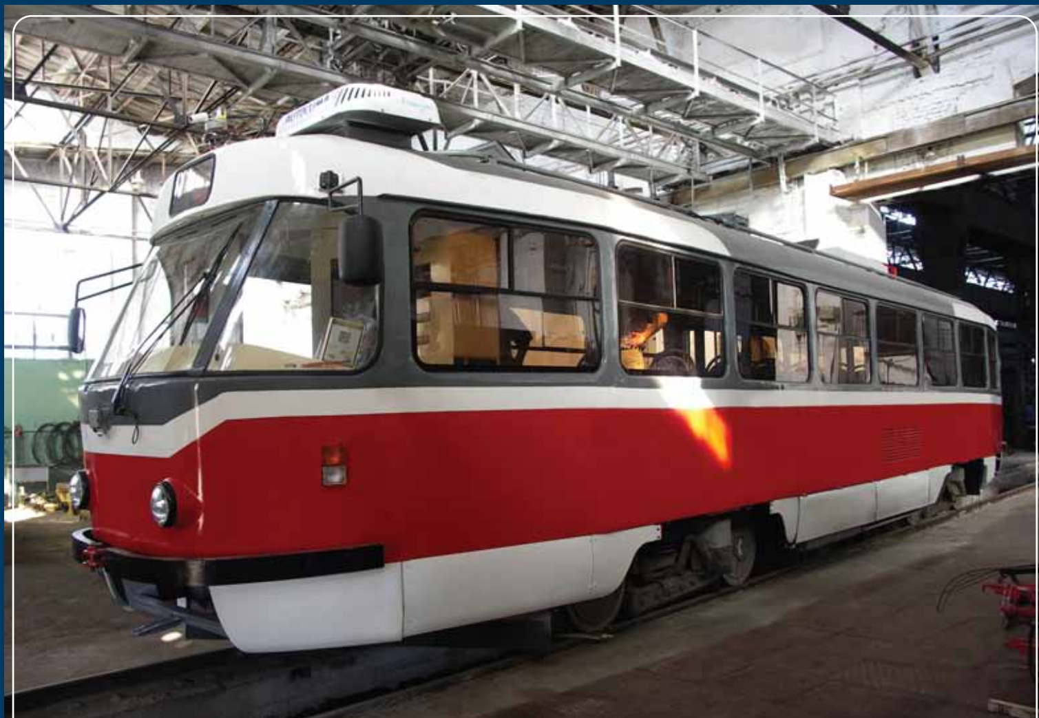
Вагон Татра Т-3 после капитально-восстановительного ремонта и модернизации
